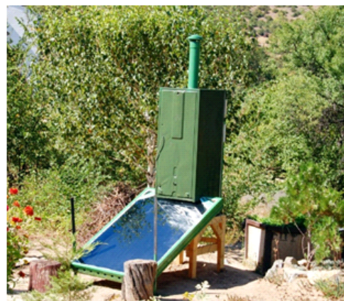
Сончева сушара (од рециклирани материјали) за сушење на производи (Извор: ЦеПроСАРА)
